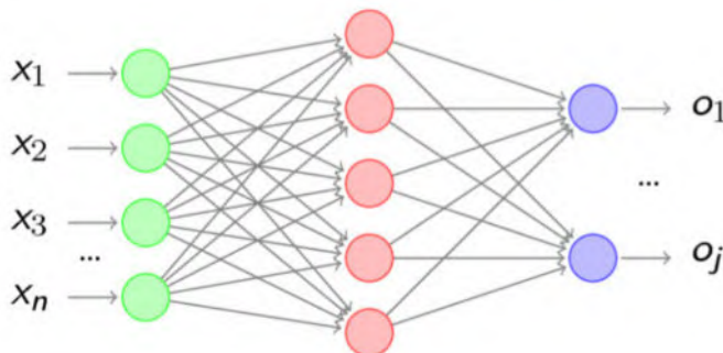
图 1.2 神经网络的全连接结构
